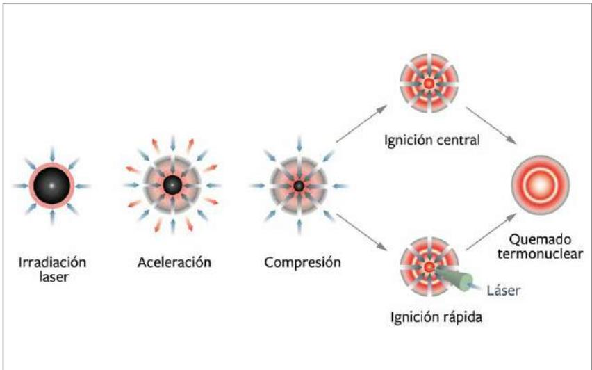
**Figura 4.7** Esquemas de ignición central o tradicional y rápida
