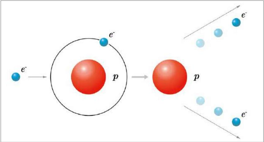
**Figura 2.6** Proceso de ionización colisional de la materia
