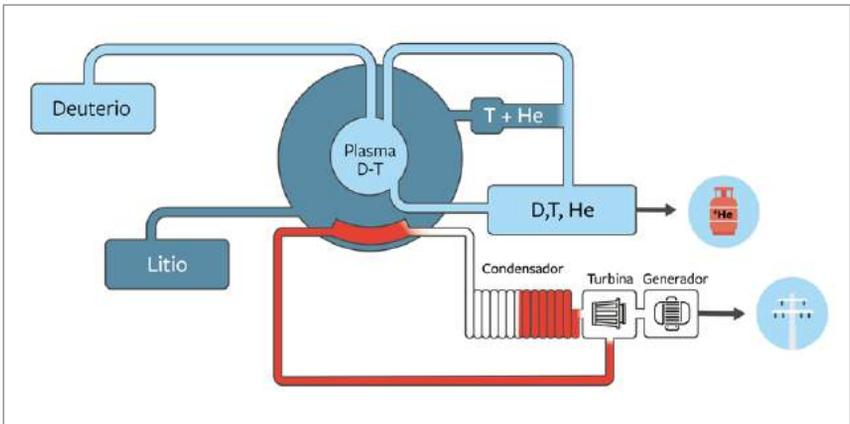
**Figura 3.1** Esquema de una planta de fusión nuclear
