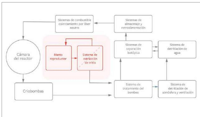
Figura 3.12 Esquema de una planta de tritio
