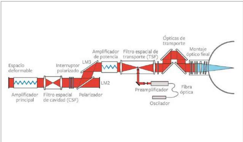
**Figura 4.2** Estructura del láser Nd de NIF
