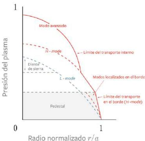
**Figura 5.3** Condiciones de confinamiento para distintos modos de operación.
