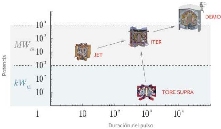
Figura 5.1 Potencia vs. duración del pulso
