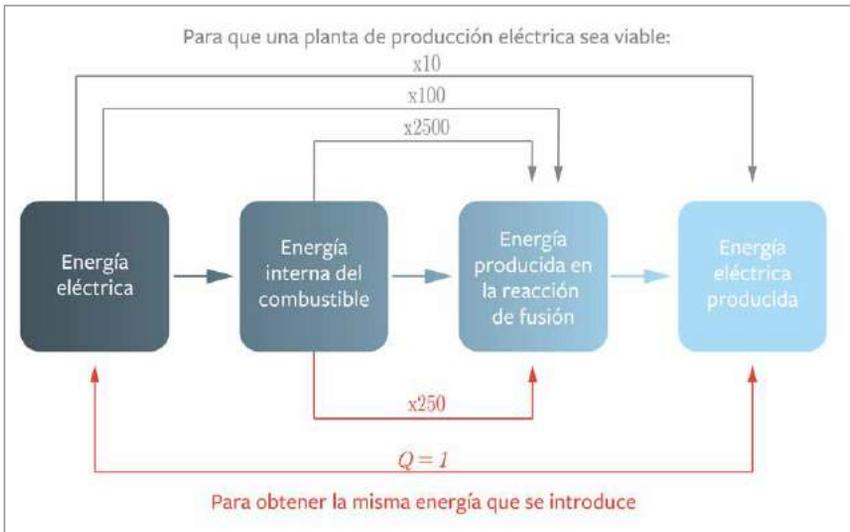
**Figura 4.11** Rendimientos requeridos para las energías o potencias en una planta
