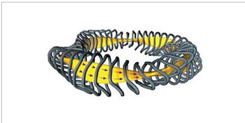
**Figura 3.11** Esquema de un Stellarator
