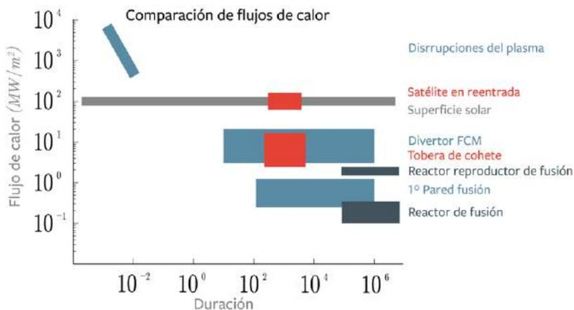
**Figura 5.8** Flujos Térmicos que se observan en diversos dispositivos tecnológicos.
