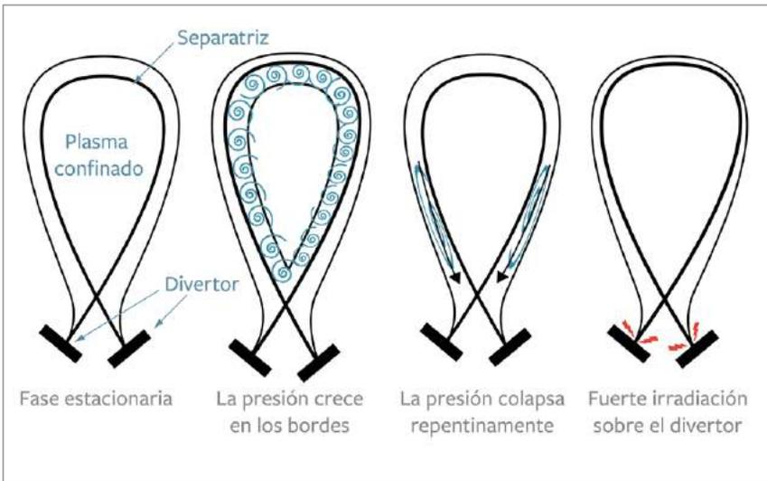
Figura 3.8 Creación y destrucción de los modos localizados en el borde (ELMs)
