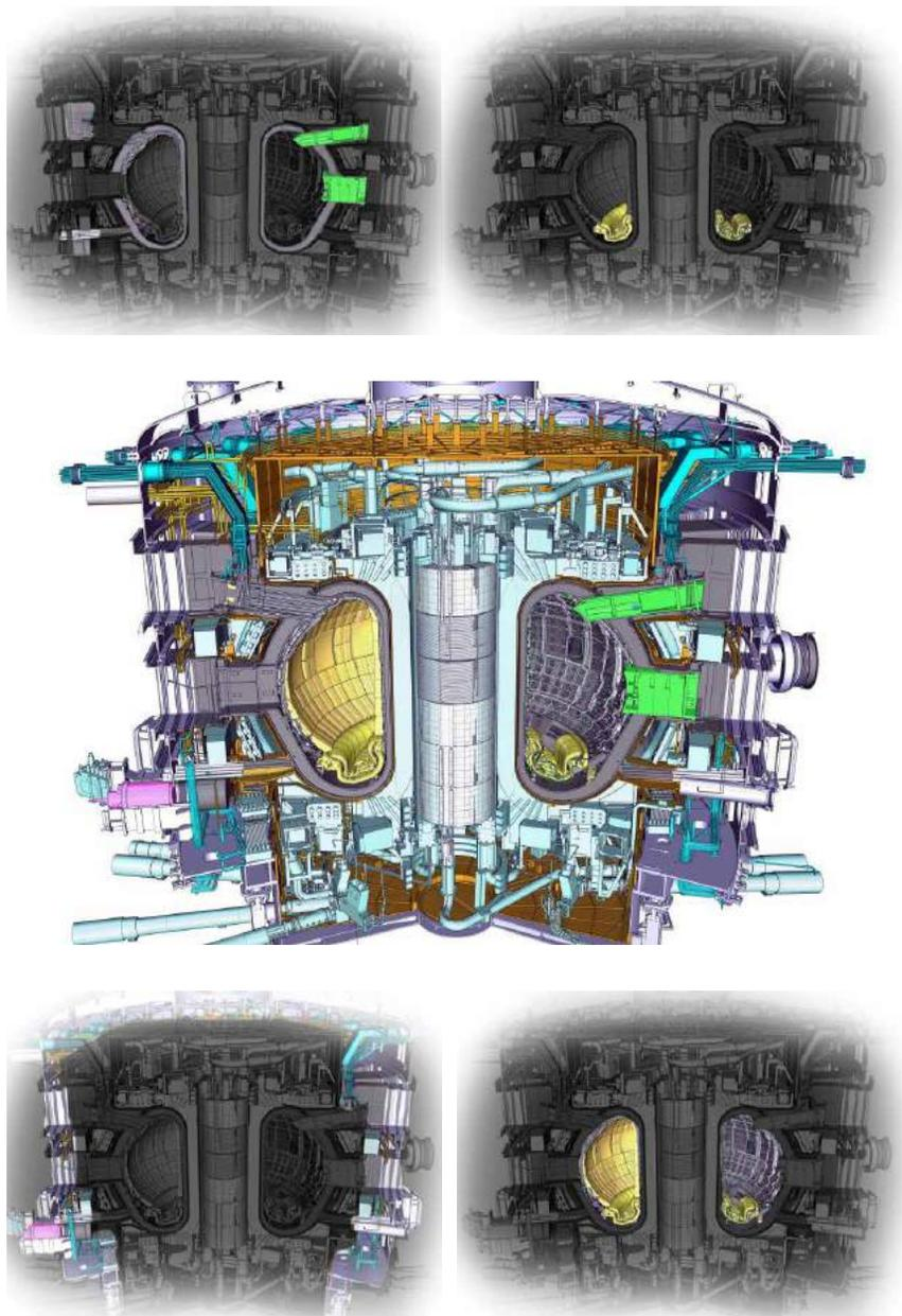
**Figura 3.10** Principales componentes de ITER: Manto reproductor (arriba izda.). Divertor (arriba dcha.). Criostato (abajo izda.). Vasija de vacío (abajo dcha.)
